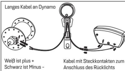
Besitzt das Fahrrad eine Dynamoschlussleuchte, so muss das Rücklicht am Scheinwerfer angeschlossen sein. Schlussleuchte und Scheinwerfer dürfen nur gemeinsam einzuschalten sein, wenn sie mit Hilfe einer Lichtmaschine betrieben werden. Die Schlussleuchte ist sowohl im Tag- als auch im Nachtmodus eingeschaltet.
