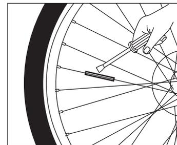
Schraubendreher an einem Ende in den Schlitz stecken und drehen.
