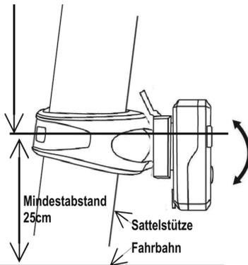
Ausrichtung parallel zur Fahrzeuglängsachse
