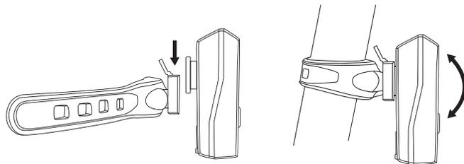
Die Rückleuchte muss fest mit dem Fahrrad verbunden sein. Die Rückleuchte so einstellen, dass diese senkrecht positioniert ist. Die Lichtverteilung darf nicht verdeckt sein. Die Anbauhöhe muss mindestens 25cm betragen und darf höchstens 120cm sein
